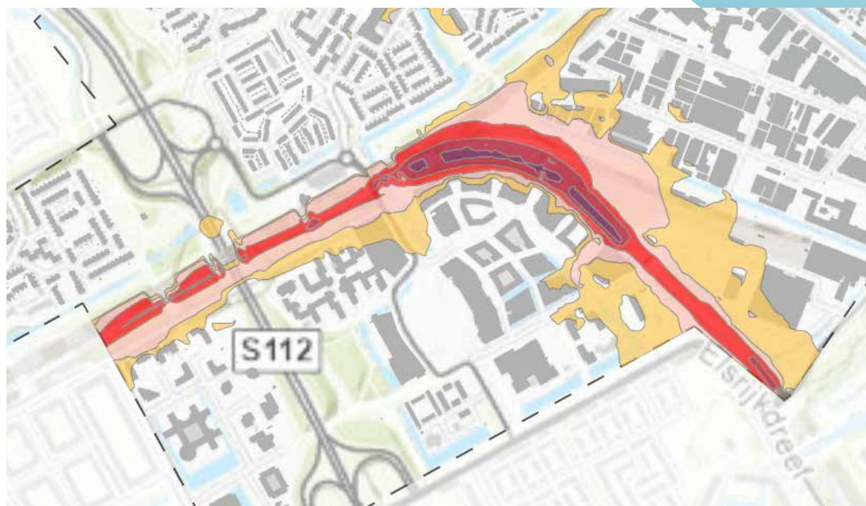
Figuur 3: Uitstraling van de metrolijn 53 naar Gaasperplas (te zien is de uitstulping naar het noorden ten gevolge van het booggeluid).
